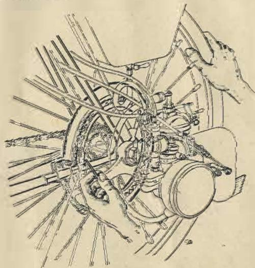
« L'INTERVALLE ENTRE LA POINTE ET LE BORD DE LA COURONNE NE DOIT PAS VARIER DE PLUS DE 0,5 mm NI DE MOINS QU'AND LE CENTRAGE EST CORRECT »
