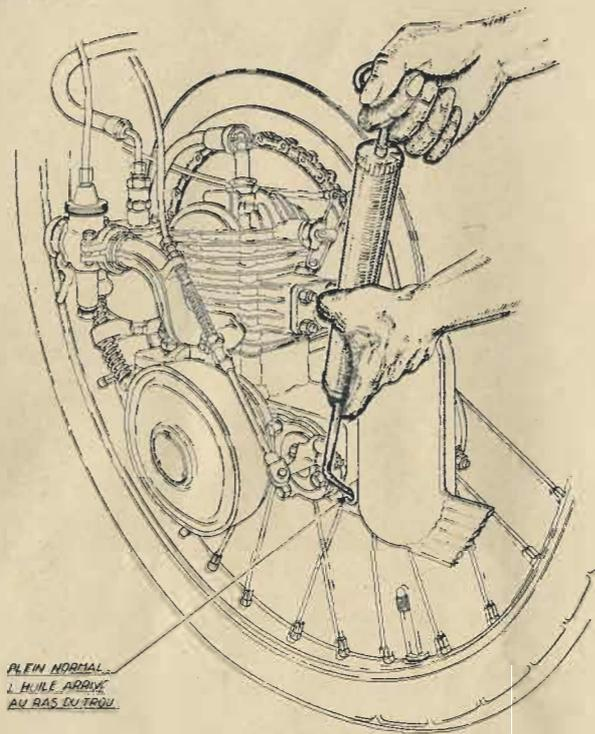
Fig. 3 - Remplissage du carter de démultiplicateur.
