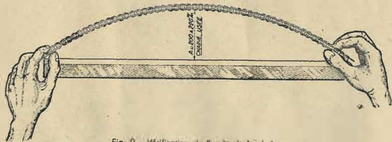
Fig. 9 - Vérification de l'usure de la chaîne.
