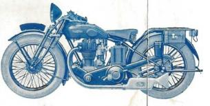
Moteur 4 temps  $71 \times 88$  à culbuteurs à double échappement.
