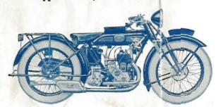
Moteur 4 temps 70 × 90 à soupapes latérales. Graissage par pompe méca-
