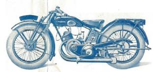
Moteur 2 temps 67 × 70 à double échappement. Allumage par magnéto. Carburateur à 2 manettes. Boîte 3 vitesses. Débravage à 3 disques. Mise en marche par pédale. Transmission par chaines. Fourche à parallélogramme. Amortisseurs réglables. Frein de direction.
