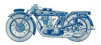
Moteur 4 temps, 81 × 97 à culbuteurs à simple échappement.
