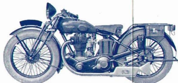
Moteur 4 temps 71 x 88 à culbuteurs à double échappement.
