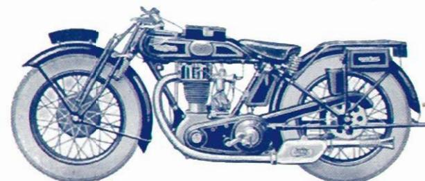
Moteur 4 temps, 81 x 97 à culbuteurs à simple échappement.
