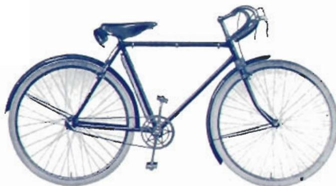
*Spécifications générales:* Cadre brasé de 52 ou 57 cm. — Pneus démontables de 700 x 30. — Jantes acier demi-nickelées. — Moyeu à 2 pignons dont un à roue libre. — Ecrans papillon avant et arrière. — Pédales course. — Garde-boue acier. — Guidon course avec poignées caoutchouc. — Sacoche de selle garnie. — Pompe de cadre. — Email grenat avec filet or. — Queue de billard et double manchon assortis.
