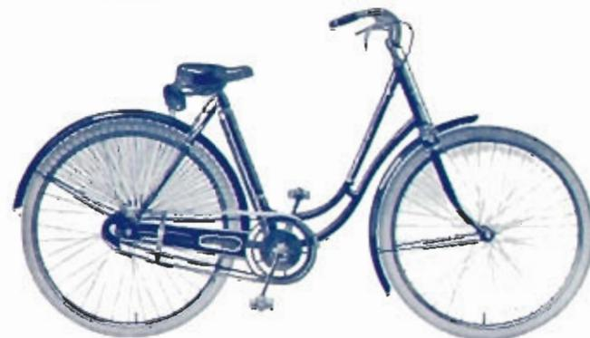
*Spécifications générales:* Cadre brasé de 52 cm. et pneus de 650 x 35 ou de 57 cm. et pneus de 700 x 35. — Jantes acier demi-nickelées. — Roue libre. — Pédales à blocs caoutchouc. — Garde-boue acier. — Guidon relevé ou genre anglais. — Carter de chaîne. — Filet garde-jupe. — Sacoche de selle garnie. — Pompe de cadre. — Email noir, filet or.
