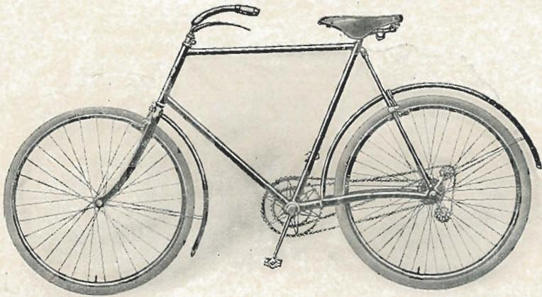
Cette bicyclette pratique et simple est notre Modèle C (voir celui-ci) complétée par notre dispositif rétro-direct 2 vitesses par chaînes Breveté S. G. D. G.
